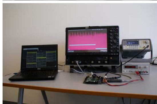
Abbildung 8: EM-Sonde zum Messen der elektromagnetischen Abstrahlung auf einem geöffneten Chip (Mitte), Messplatz zur Poweranalyse eines Mikrocontrollers und FPGA-Platine zu dessen Steuerung (oben und unten) im Testlabor des Fraunhofer SIT-München
